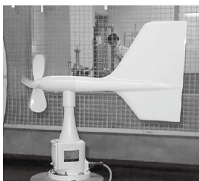
図16 プロペラ型風向風速計
